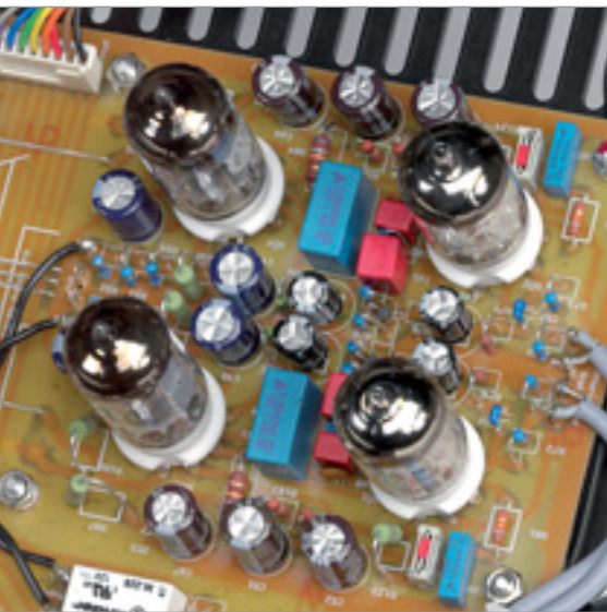
Phono-Sektion mit engtolerierten WIMA-Kondensatoren und Valvo-NOS-Röhren
