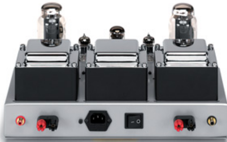
Bei meiner Kritik an schlecht erreichbaren Netzschaltern bleibt es auch in diesem Fall. Die Trafopakete wurden mit auffallend dünnen Blechen geschichtet
