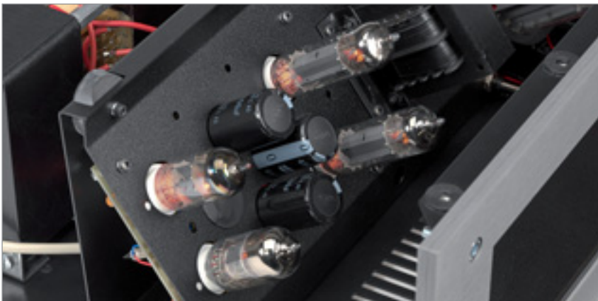
Dank der Treiberdrossel reichen zwei PL84 aus, um die Schirmgitter von vier PL519 leistungsgebunden anzusteuern
