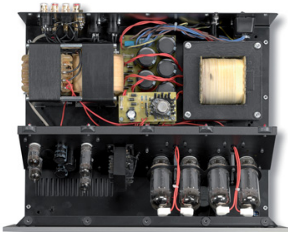
Der Transformator rechts dient der Energieversorgung, die beiden zierlichen Übertrager links erfüllen die Funktion eines großen und haben keinerlei Probleme mit der Ausgangsleistung von 300 Watt
